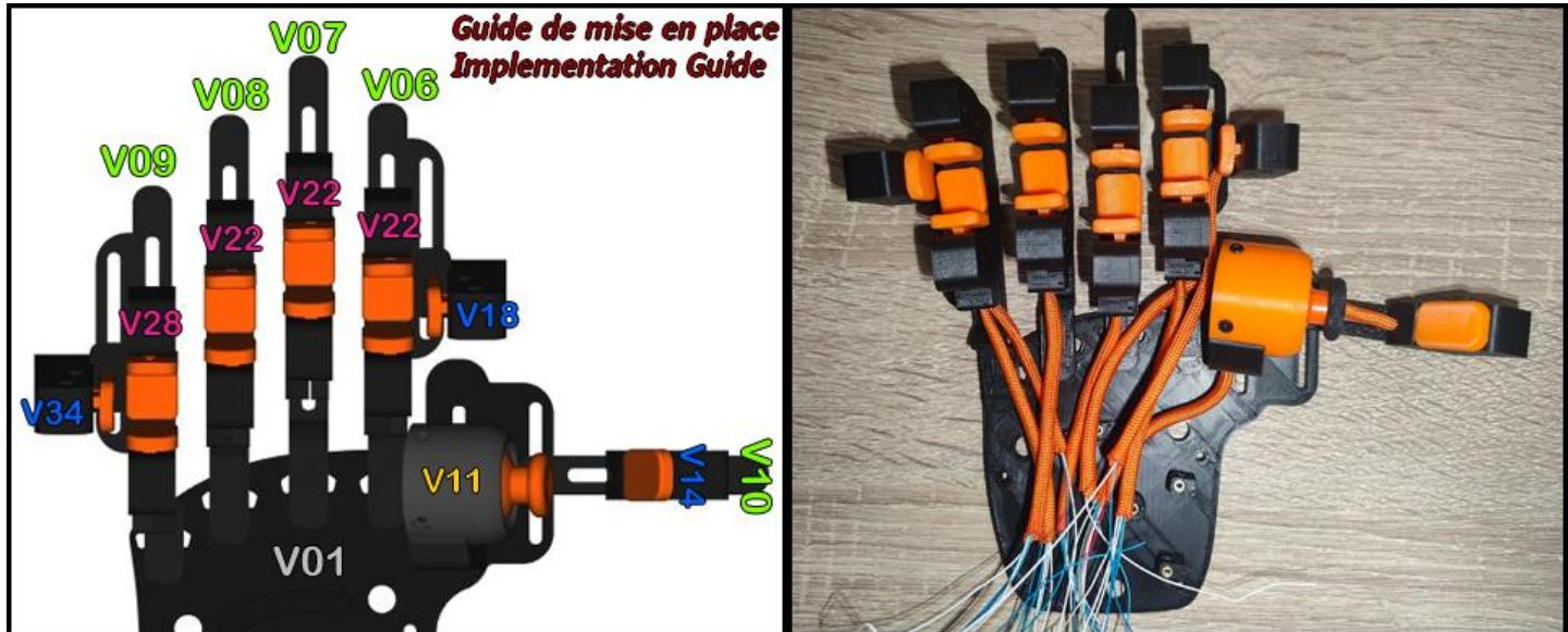
18. Utiliser des vis **M3 × 10 mm** et des rondelles **M3** pour fixer l'ensemble par en dessous.
