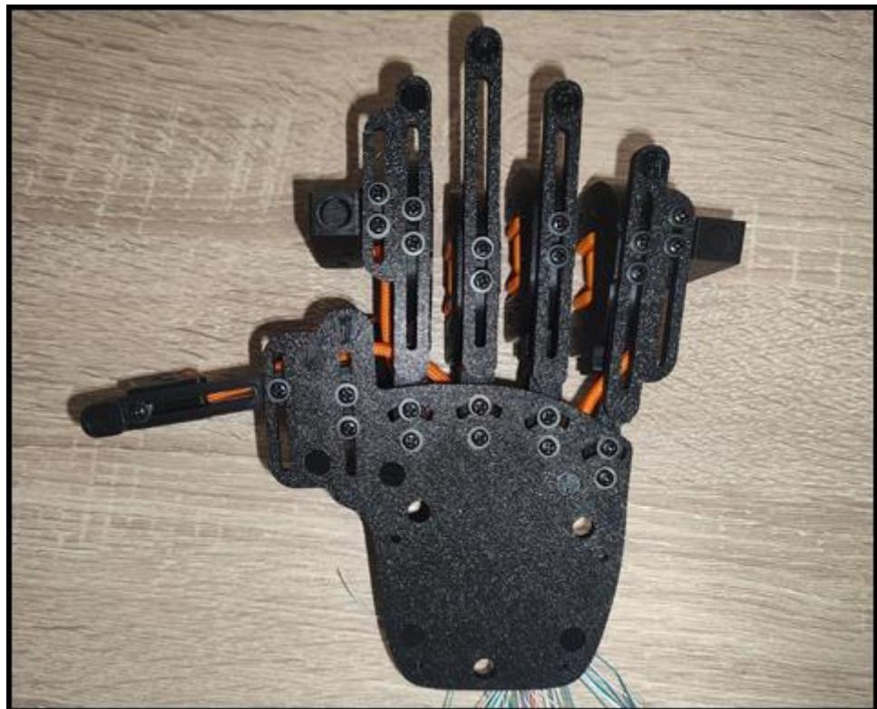
19. Ranger correctement les câbles sur le fixateur prévu : placer **4 câbles par emplacement**, puis fixer le tout avec la pièce **V05** et **3 vis M2 × 8 mm**.
