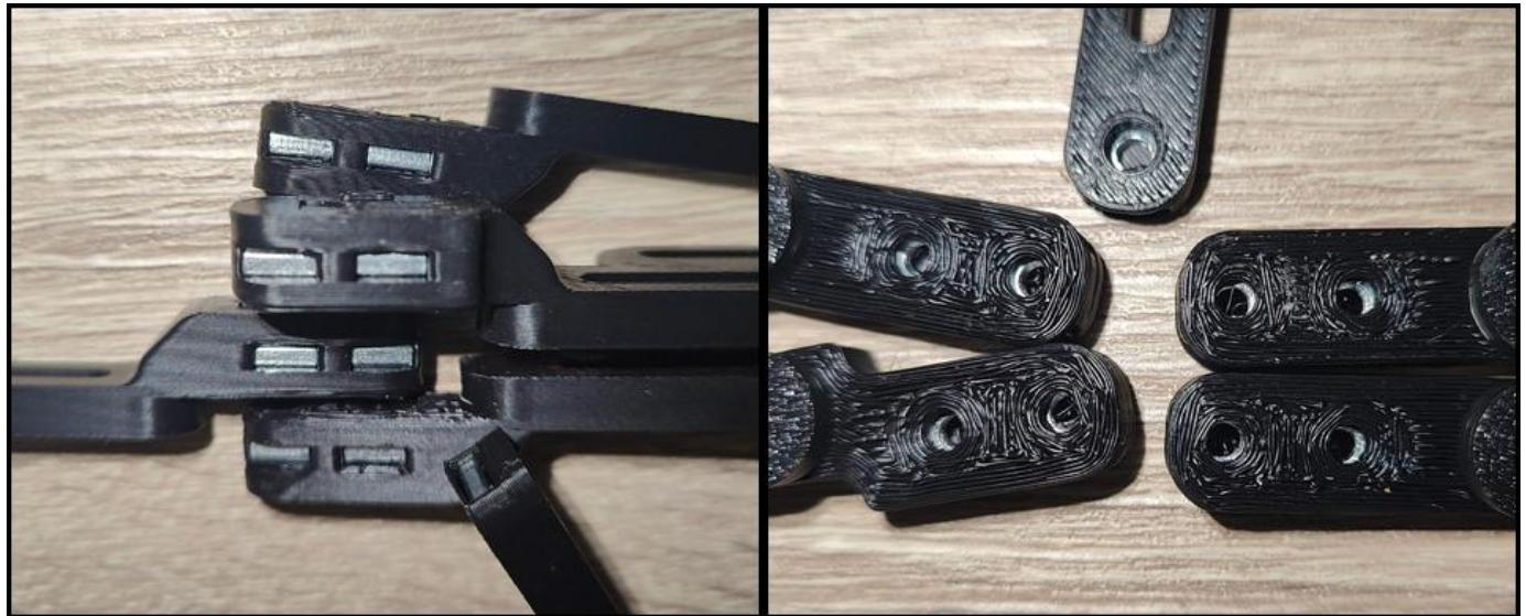
15. Insérer **2 écrous carrés M3** dans leurs emplacements de la pièce **V11** (joystick).
