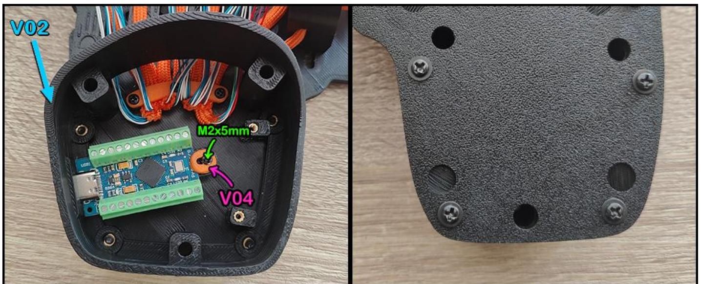
21. Placer le **connecteur KF128 / 6 pins** soudé au PCB dans son emplacement et fixer l'ensemble avec **2 vis M2 × 8 mm**. Il ne reste plus qu'à relier tous les fils à leurs emplacements en suivant les **schémas de câblage** (*de la page suivante*).
