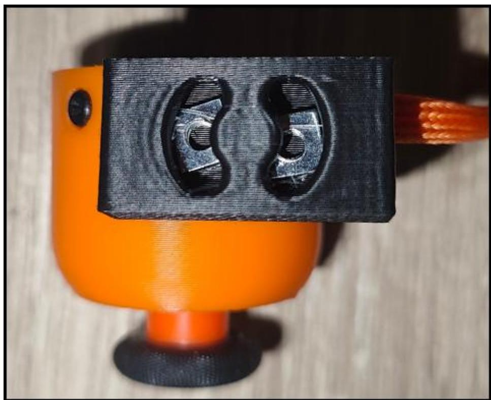
16. Positionner la pièce **V11** à son emplacement sur la pièce **V01** et utiliser **2 vis M3 x 10 mm** et **2 rondelles M3** pour fixer l'ensemble.
