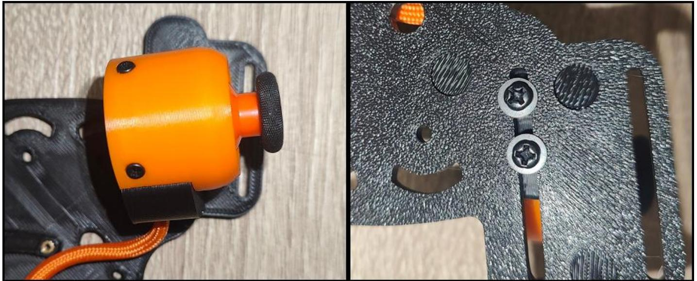
17. Positionner les supports des boutons sur les rails des doigts et placer les assemblages en suivant le guide.
