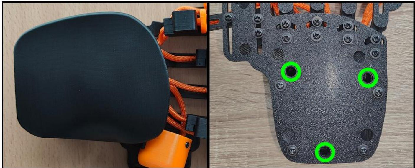
23. Coller les **14 pastilles en silicone adhésives** ( $\varnothing 8 \text{ mm} \times 4 \text{ mm}$  d'épaisseur) aux emplacements prévus.
