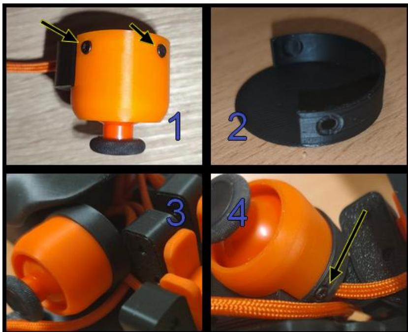
*La pièce VX est une bague qui permet de cacher les trois vis de la cloche du joystick. Vous devez utiliser uniquement des vis à tête plate pour pouvoir emboîter la bague de finition.*
